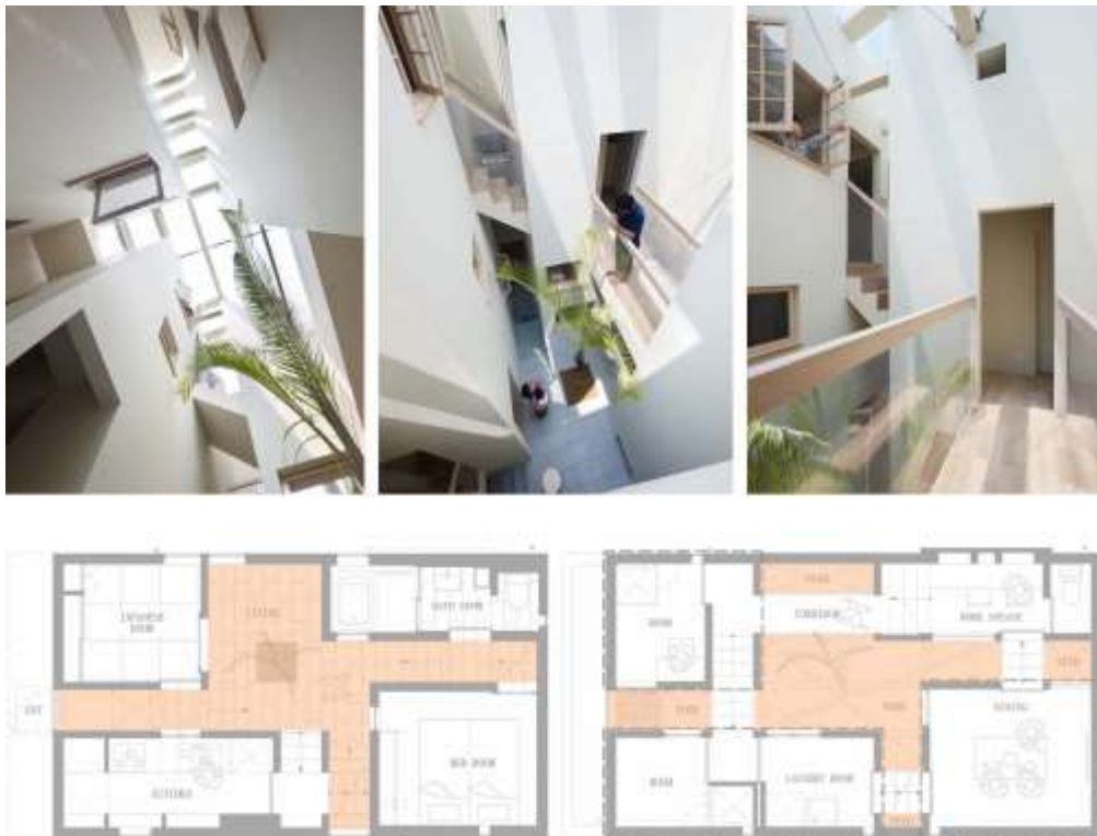
6. En haut, photographies intérieures de la House in Goido de FujiwaraMuro Architects (© Toshiyuki Yano) ; en bas, les plans du premier et du second niveau de la maison sur lesquels on peut clairement identifier les quatre blocs indépendants organisés autour d'une cour intérieure, ou « atrium » (© FujiwaraMuro Architects)
