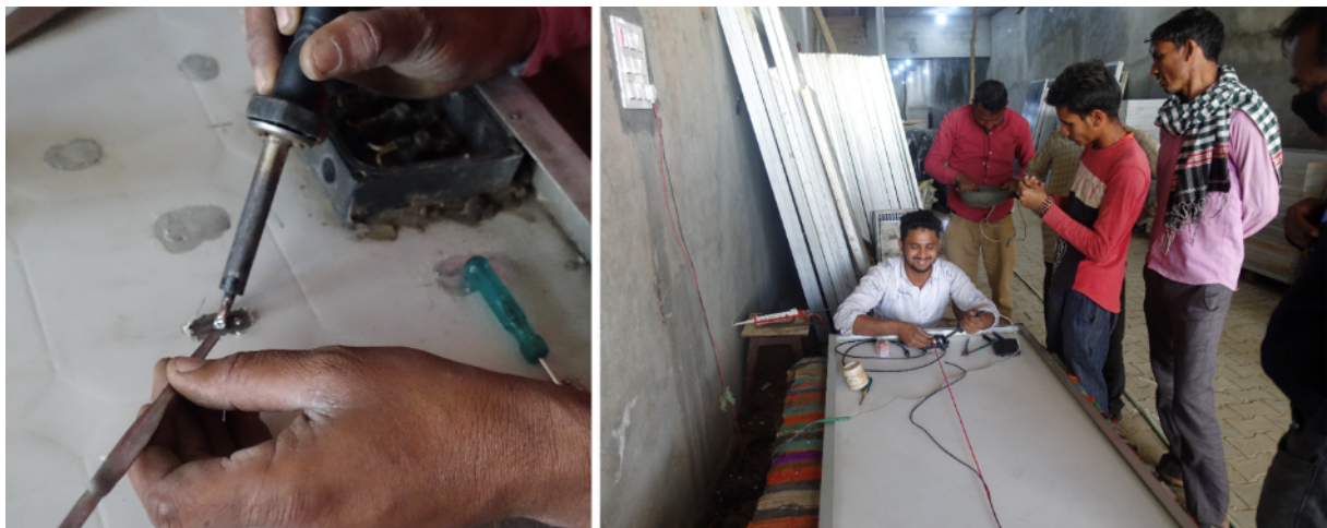
24. Modification de panneaux solaires d'occasion. Adaptés pour charger une simple batterie 12V (commune et répandue), ces panneaux solaires vivent une seconde vie dans les zones rurales de l'Inde, où ils sont plébiscités par les ménages en situation de pauvreté énergétique. Uttar Pradesh, Inde (Rémi de Bercegol, 2022)
